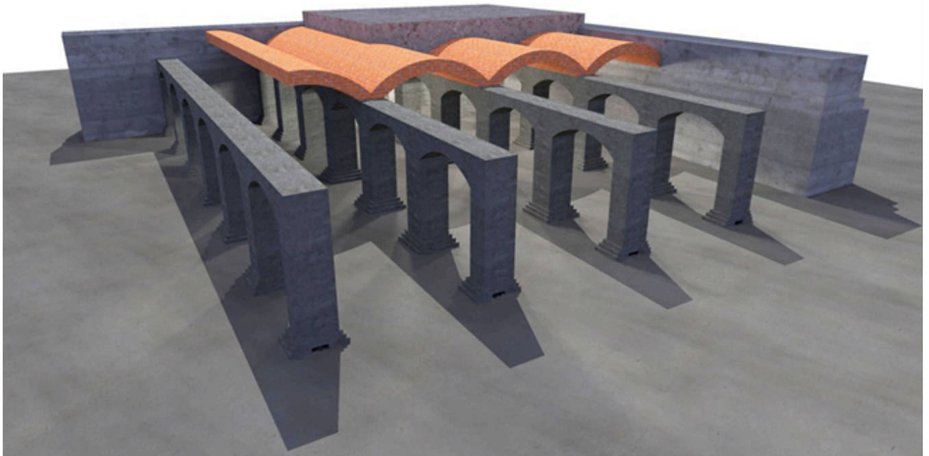
FIGUUR 6: RESERVOIR STRUKTUURELEMENTE
